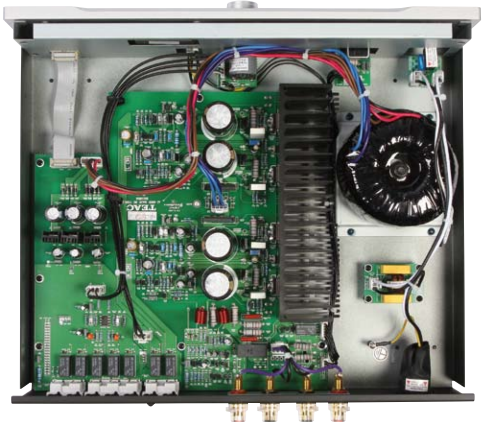
GUT VERSORGT: Für besonders widerstandsarmen Zug aus der Strompulle hat Teac vier 10000µF-Siebkondensatoren (Typ ELNA „For Audio“) direkt an den Endtransistoren platziert.
