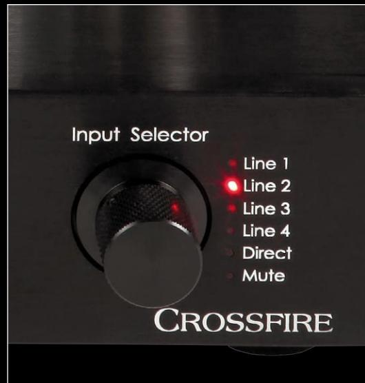
Links: Die Lautstärke-Regelung ist aufwendig über ein Netz analoger Widerstände geregelt, die von einem Digital-Prozessor gesteuert sind. Rechts: Die „Direct“-Taste verwandelt den Crossfire III zur reinen Endstufe. Bei hochwertigen Playern mit eingebauten Vorstufen ist diese Funktion durchaus sinnvoll.
