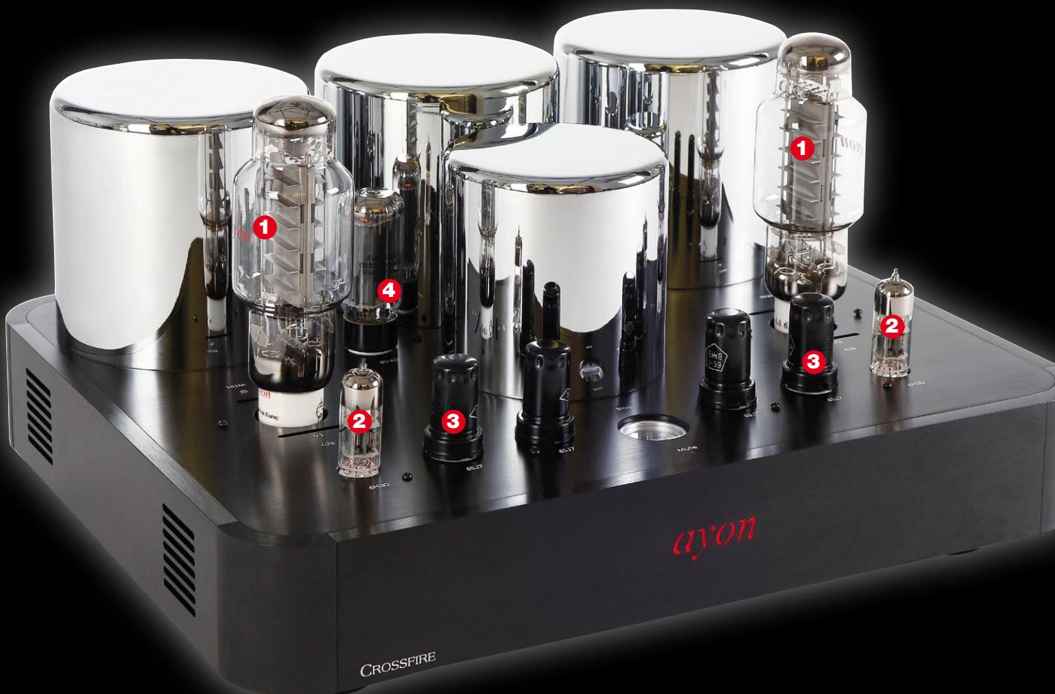
Die hinteren verchromten MU-Metalltöpfe schirmen den Netztrafo und die Ausgangsübertrager ab. Unter dem vorderen Topf (Pfeil) sitzt eine Drossel, die zusammen mit einem Kondensator eine Netzteil-Siebung vornimmt. Eine zusätzliche Stromfilterung über Kabel oder aktive Filter ist deshalb wenig sinnvoll.
