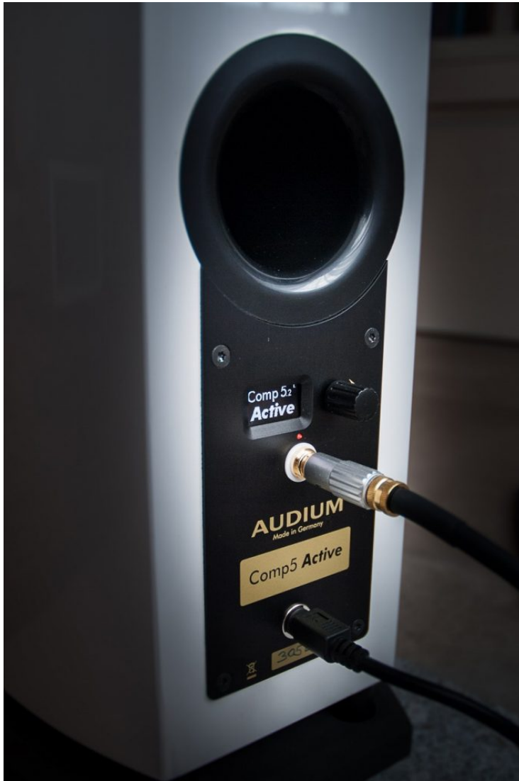
AUDIUM Comp 5.2 Active – das Anschlussterminal mit Benutzerschnittstelle (Foto: Falk Visarius)
