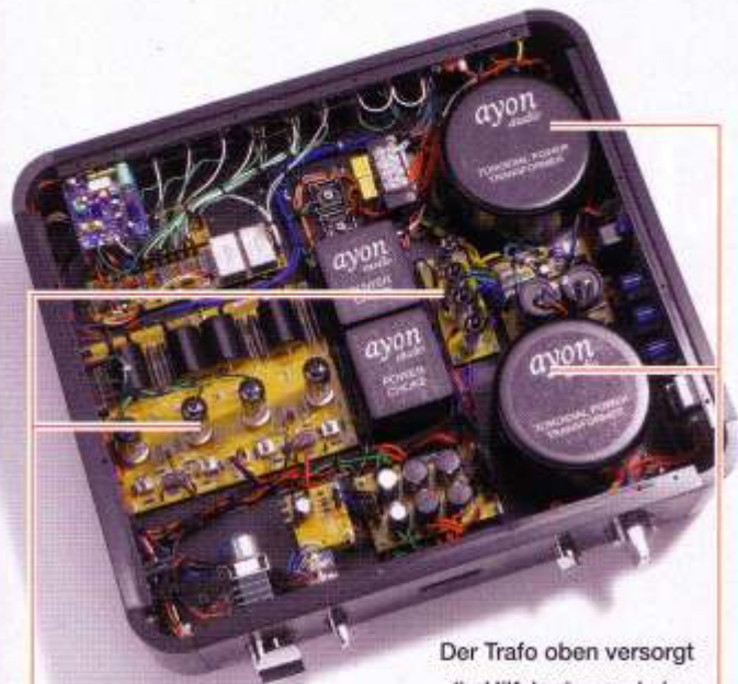
Ayon Orbis: Doppeltrioden mit parallelen Systemen verstärken, vier Doppel-dioden richten gleich.
