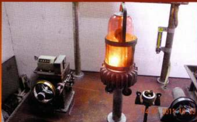
Alchemie: Bevor der Wolframfaden (unten) die Röhrenkathode bilden darf, schenkt ihm ein Glutkolben ein goldenes Kleid.
